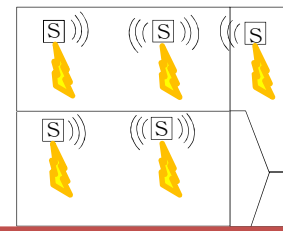
無線式の連動型警報付感知器を用いる方式（2階以下特定小規模施設、警戒区域が1）
