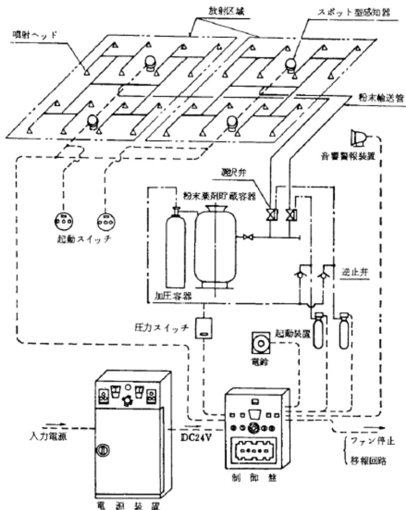
図8-2 粉末消火設備粉末容器附属機器回路
