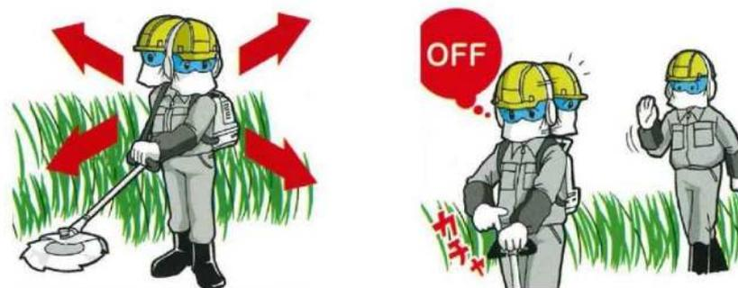
図13 作業中の周囲の安全確認とエンジン停止
