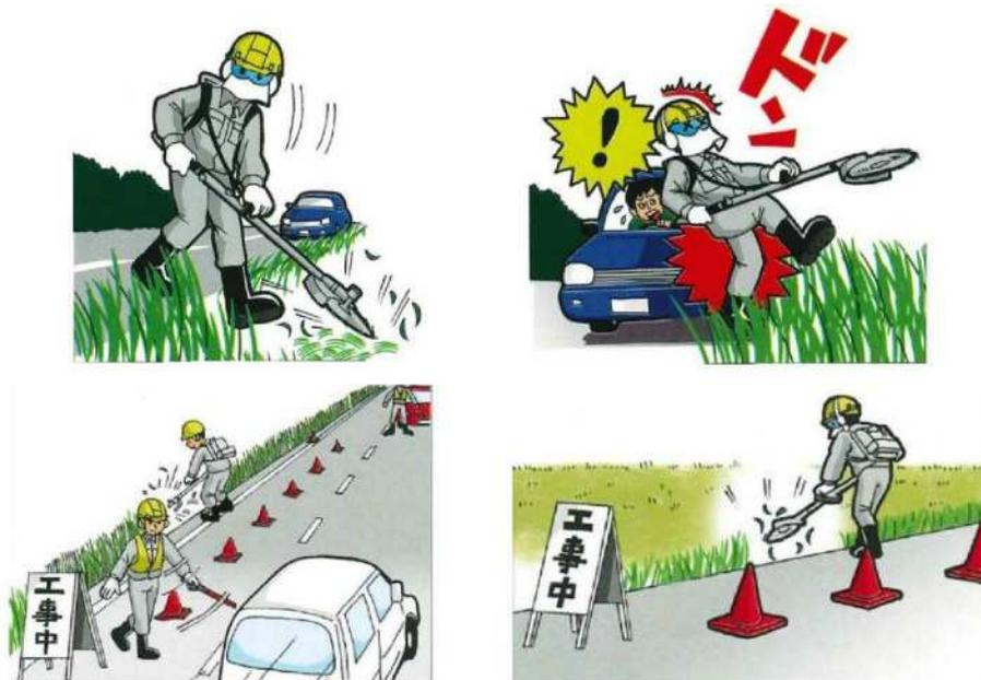
図20 車道の車両との接触注意と作業範囲の規制
