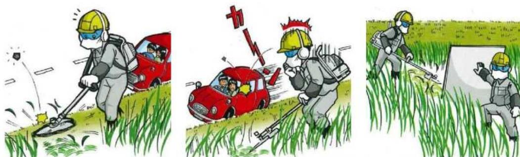
図18 道路付近での除草作業と飛石事故及び防護パネルの利用
