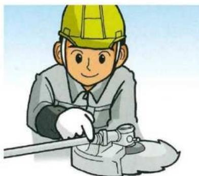
図4 飛散防護カバーの確認
