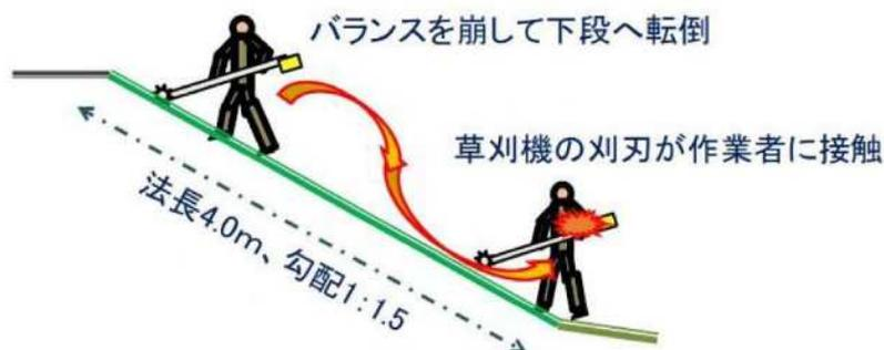
図2 上段作業者の転倒による下段作業者への接触事故例（参考図）
