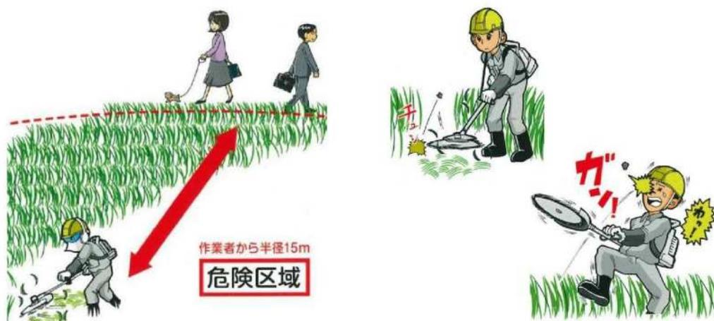
図17 飛石の発生と作業者への衝突
