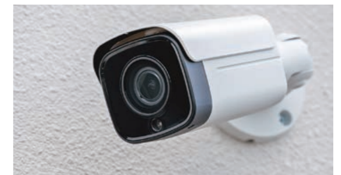
防犯カメラの設置
