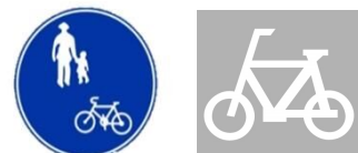
「普通自転車歩道通行可」の道路標識・道路標示
