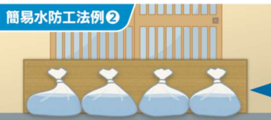
簡易水のう+止水板 簡易水のうを作り、長めの板などと組み合わせ、出入口に設置し、浸水を防ぎます。
