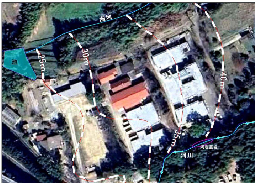
図 4.1-2 基盤岩 (花崗岩) 上面等標高線図 (Google 写真を引用・編集)
