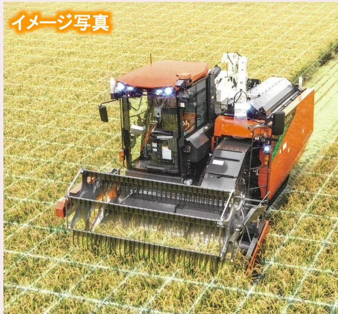
GS(直進アシスト)機能を有するコンバイン
